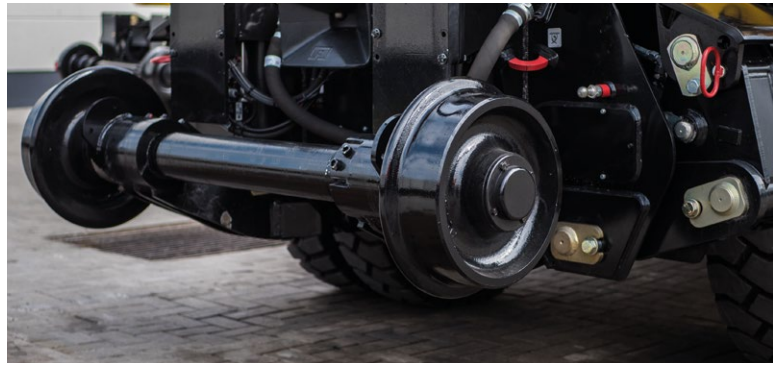
Als Option lieferbar: Friktionsantriebssystem lieferbar für 1404 ZW-CR mit Gleisbreite 1000 mm.
