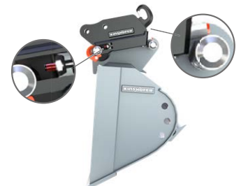
Nicht korrekt verriegelt. Riegelbolzen sind über dem zugelassenen Bereich. Anzeigestift ist ausgefahren.
