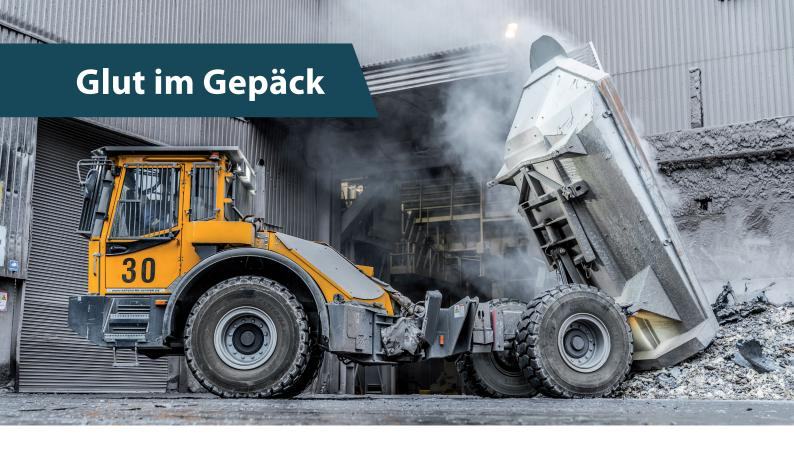
Tag für Tag verrichten die beiden Bergmann 3012 DSK in den Hallen der voestalpine Stahl GmbH echte Schwerstarbeit. Die Ladung, die die Dumper transportieren, ist heiß – bis zu 700 °C. Es handelt sich um Schlacke aus der Stahlherstellung, welche teilweise noch glühend heiß aus dem Stahlwerk hinaus auf eine Halde abtransportiert werden muss.
