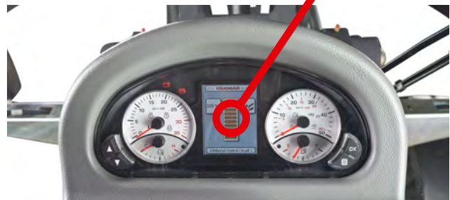
Setup-Menü für die Einstellung der Einheiten wie Geschwindigkeit, Temperatur und weitere
