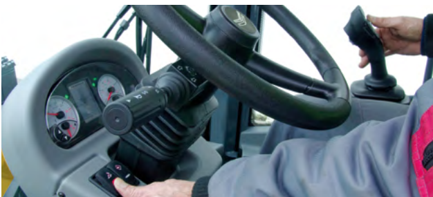
Einstellung der Ölmenge des dritten und vierten Kreises ueber das Display.
