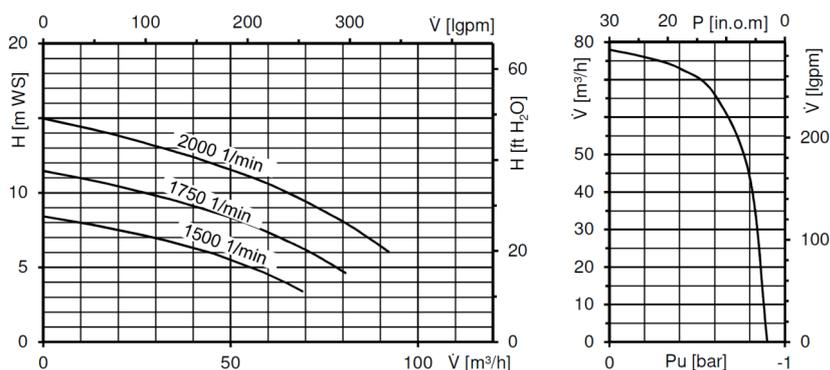
Pumpenkennlinie 2000 1/min,
