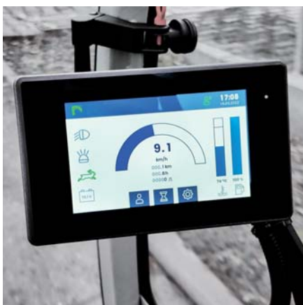
Farb-LCD-LED-Touchscreen mit Anzeige von Echtzeitdaten und zur Auswahl der Automatikprogramme, Fahrprofile, ...
