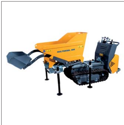
Raupenfahrgestell von MM-150-D beim Wechsel des Aufbaus MM-KA
