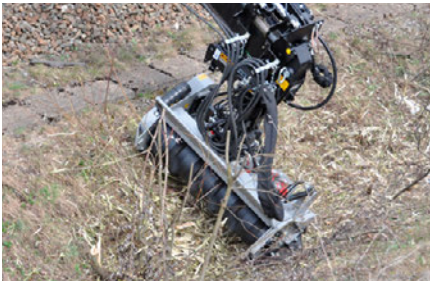
KM 931 angebaut an einem fest montierten Kranarm (hier mit einem Mulcher)
