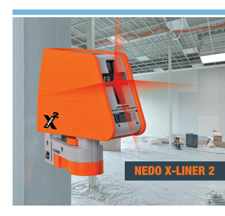
Die übersichtliche Tastatur ermöglicht eine einfache Handhabung. Das zuverlässige, magnetisch gedämpfte Pendel garantiert jederzeit präzise Ergebnisse. Schräglagen des Geräts bis zu 4° werden automatisch ausgeglichen.
