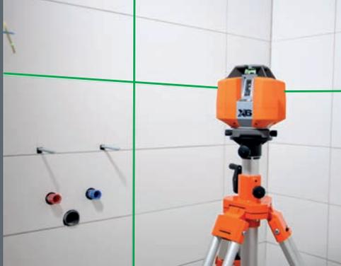
Grüner Multilinen-Laser mit einer horizontalen 360° Laserlinie und vier senkrechten, jeweils im Winkel von 90° angeordneten Laserlinien und einem senkrechten Lotstrahl nach unten
