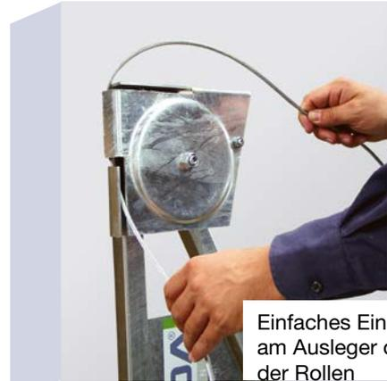
Einfaches Einlegen des Seiles am Ausleger ohne Demontage der Rollen
