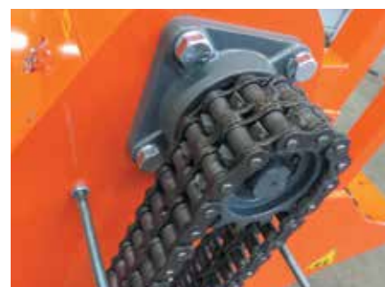
Antrieb über Duplex-Kette
