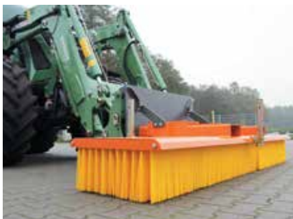
Schnellwechselanbau für Frontlader (Euronorm)
