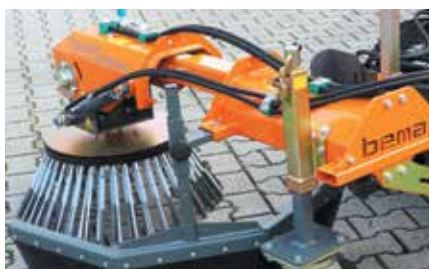
Teleskopierbare Seitenverschiebung um 300 mm
