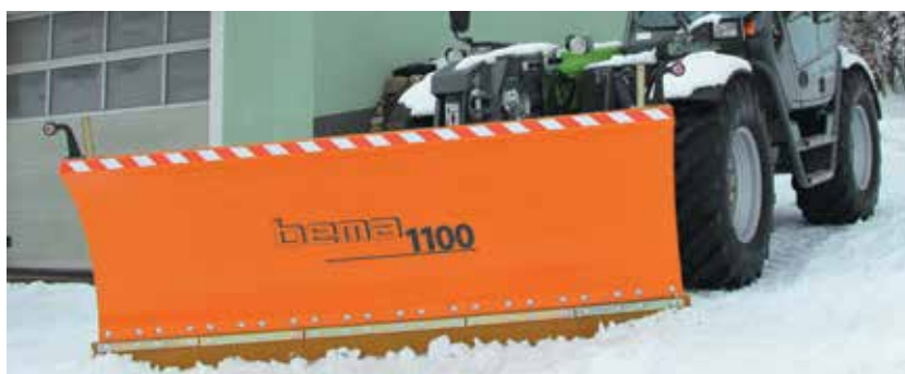
bema Schneeschild Serie 1100, Teleskopladeranbau (Schnellwechselladung)
