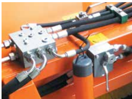
Hydraulikblock und bema SideControl
