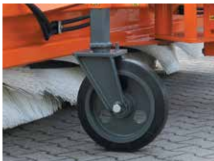
Stabile Laufräder (Gussfelge mit Radlager)
