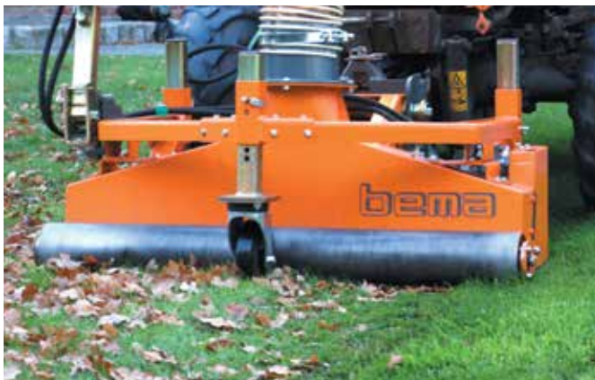
bema Saug-Kehrdüse ohne Häckselgebläse und mit Saugcontainer im Heck
