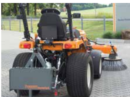
bema PowerPack - Hydraulisches Antriebsaggregat
