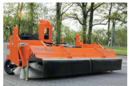
bema 3 Airport standardmäßig mit Spritzschutz
