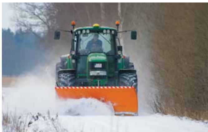
bema Schneeschild Serie 1100, Schlepper (Fronthydraulik)
