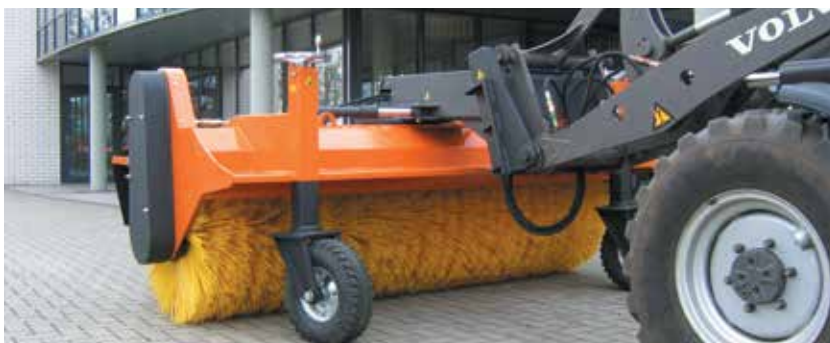
bema Jumbo am Radlader (Schnellwechselanbau mit Rollenniveaueingleich)
