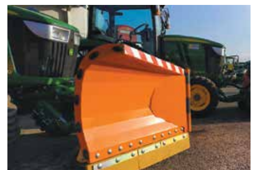
bema V-Schild V800, Anbau Kompaktschlepper
