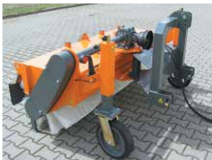
Getriebe & Räder Ø 360 x 85 mm (Sonderbau)
