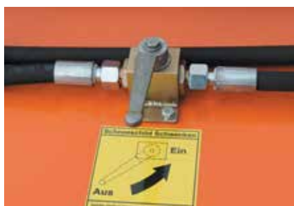
Absperrhahn zum Verriegeln des hochgeklappten Schneeschildes
