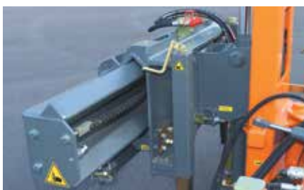
Hydraulische Seitenverschiebung um 500 mm
