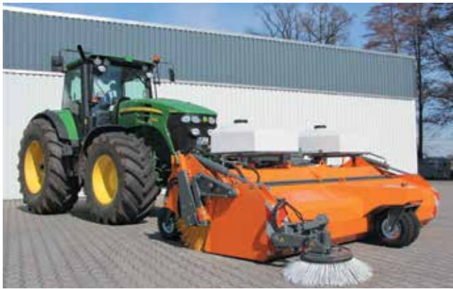
bema Titan Dual am Schlepper (Frontanbau)
