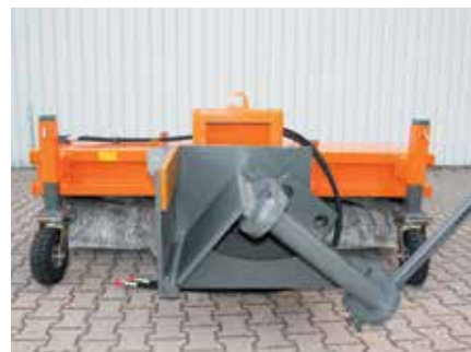
Schwenkbarer Baggeranbau (Sonderanbau)
