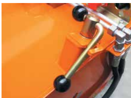
Stufenlose Verstellung des Anpressdrucks
