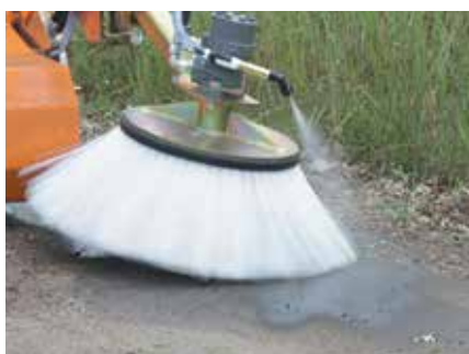
Seitenkehrbesen mit Wassersprüheinrichtung
