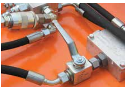
Schwenkdrossel & Mengenteiler (gleichmäßiges Anheben des Schneeschildes)
