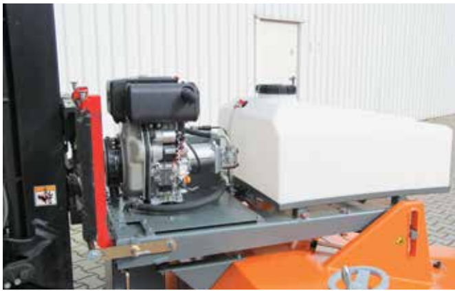
Version mit Diesel-Verbrennungsmotor und Bordhydraulik
