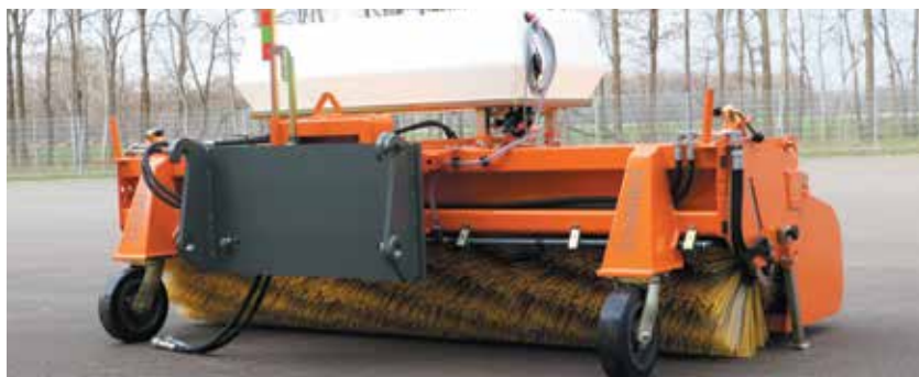
Schnellwechsellanbau mit Rollenniveaueingleich und bema-Meter
