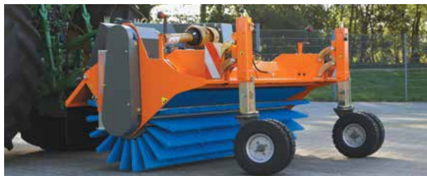
bema Jumbo Airport im Schlepper-Heck, Sonderbau mit Stützradverstellung
