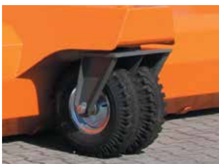
Stabile Zwillinglaufräder Ø 460 x 145 mm
