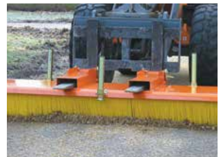
Palettaufnahme mit werkzeugloser Arretierung
