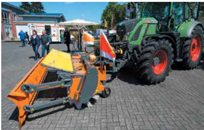
bema Snow-Combi am Schlepper mit optionalem Schneestaubschutz
