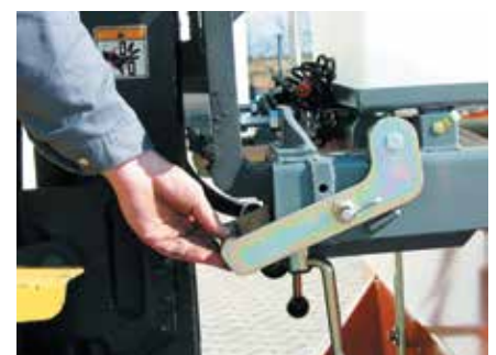
Verriegelung der Aufnahme am Gabelstapler
