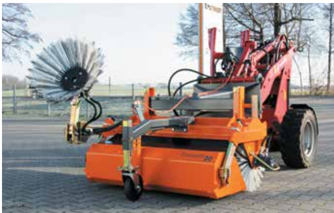
Entleerung der Sammelwanne mit Seilzug (mechanisch), Seitenkehrbesen
