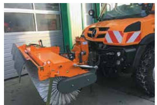
Unimog-Anbau, hydraulischer Aushub
