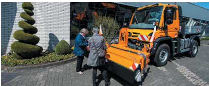
bema 3 Robust - Anbau Unimog-LKW mit hydraulischer Seitenverschiebung
