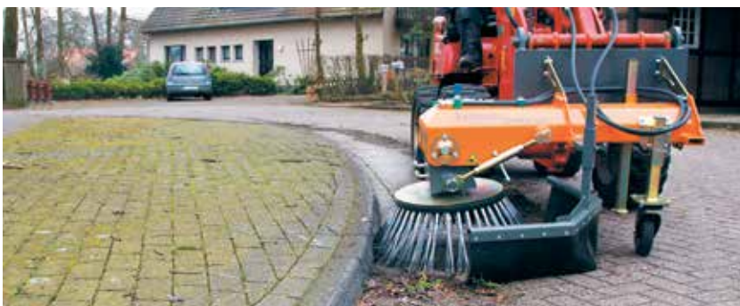
bema Groby light, Hofladeranbau (Schnellwechseleinrichtung)
