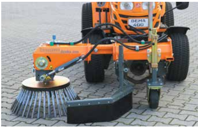
Flexibel dank der teleskopierbaren seitlichen Verschiebung (300 mm)
