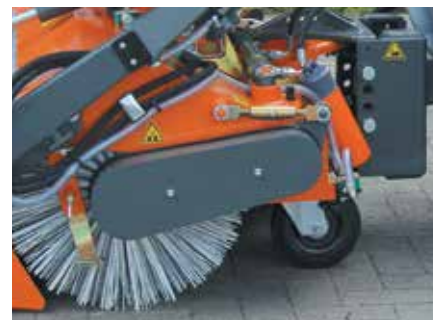
Stufenlose Kehrwalzenverstellung (Spannschloss)
