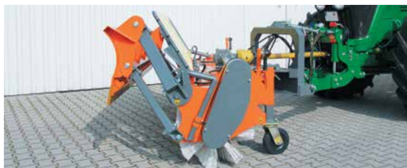
bema Snow-Combi, Schlepperanbau (Dreipunktbock)
