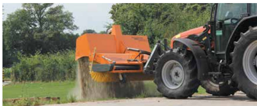
Hydraulische Entleerung der Schmutzsammelwanne
