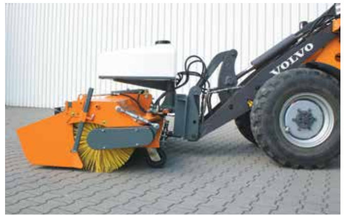
bema Kommunal 600 Dual, Radladeranbau (Schnellwechseinrichtung)
