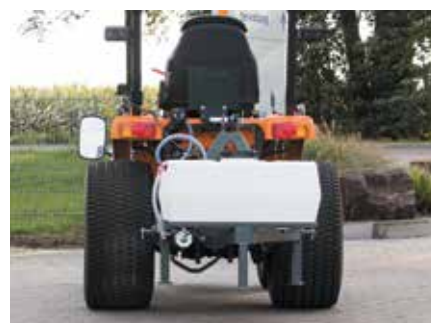
Wassertank im Heck
