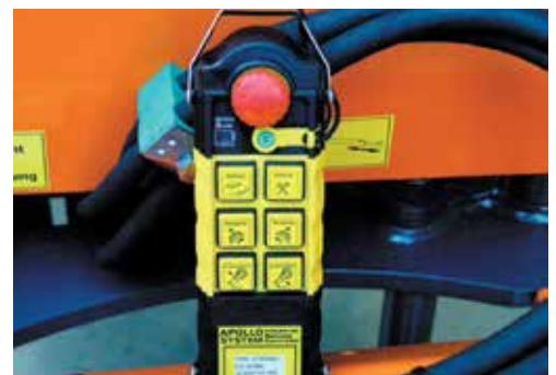
bema Control - Steuergerät inkl. Funk-Fernbedienung
