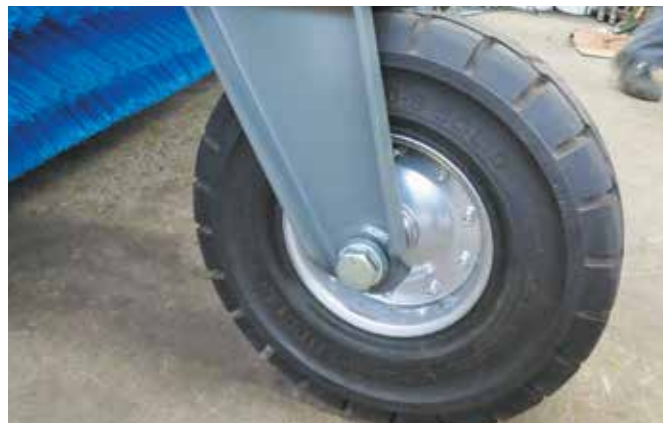
Stabile Laufräder (Ø 460 x 145 mm)
