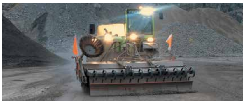
bema 75 Dual PowerMaster mit bema Aufkratzvorrichtung und Hochdruckspülanlage
