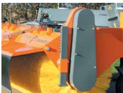
Kettenkasten (seitlicher Kettenantrieb)
