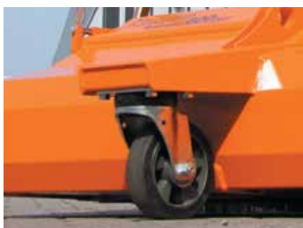
Schwerlastlaufräder Ø 160 x 50 mm
