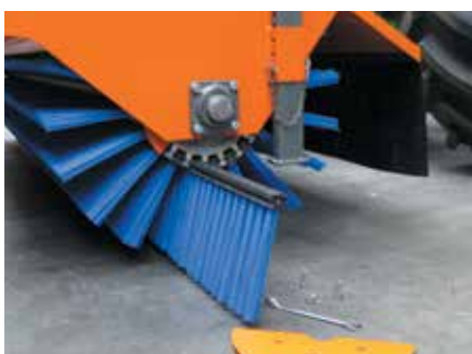
Kassettsystem mit Bürstenelementen
