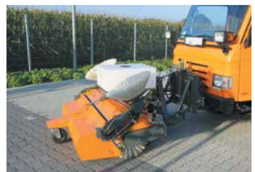
Anbau am Kommunalfahrzeug, hydraulischer Aushub
