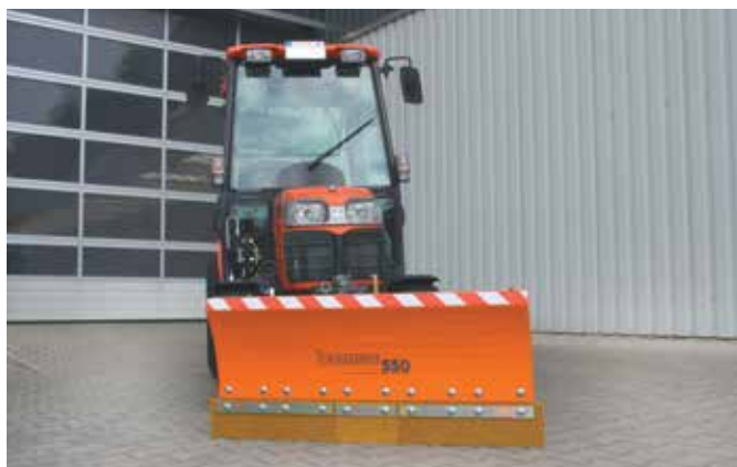
bema Schneeschild Serie 550, Anbau Kompaktschlepper (Dreipunktbock)
