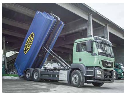
Mehr Spielraum bei Überdachungen durch den niedrigeren Aufbau des Abrollkippers.
